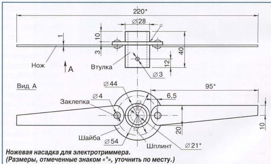
Ножевая насадка. Главные её достоинства: простота конструкции и очень высокая эффективность.
