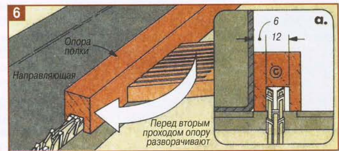
Второй проход для выборки паза в опоре полки.
