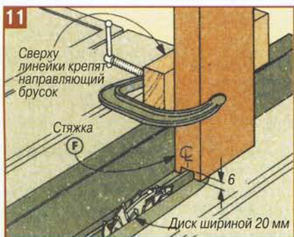
Изготовление пазов в стяжках.
