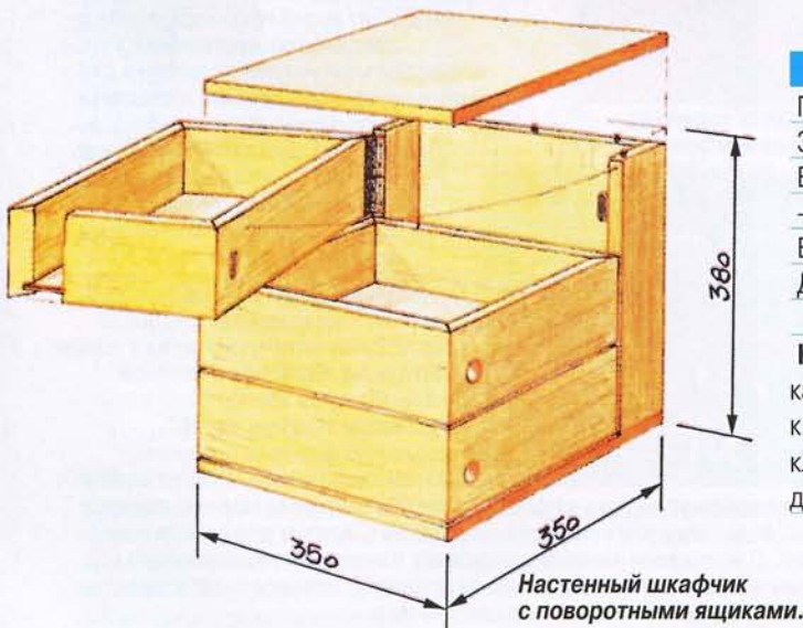
Корпус настенного шкафчика с магнитными защелками, удерживающими поворотные ящики в закрытом положении.
