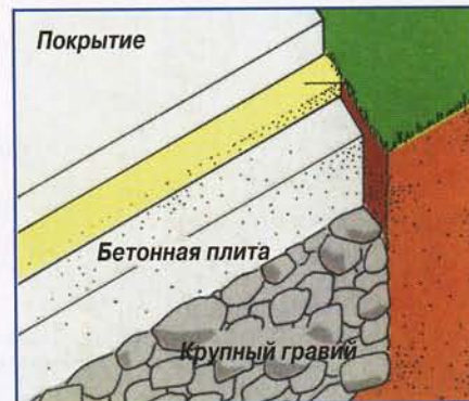
Рис. 1. Фундамент представляет собой бетонную плиту, отлитую на слой крупного гравия. В условиях глинистого или болотистого грунта под стены закладывают дополнительный ленточный фундамент толщиной около 30 см.
