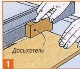
Через диск дисковой пилы подают доску досылателем с «пяткой».
