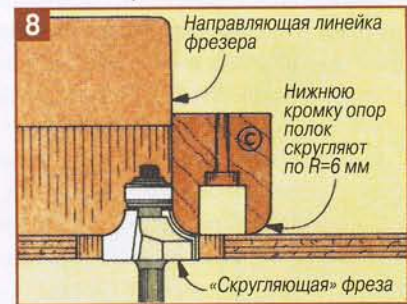
Скругление кромок опор полок.
